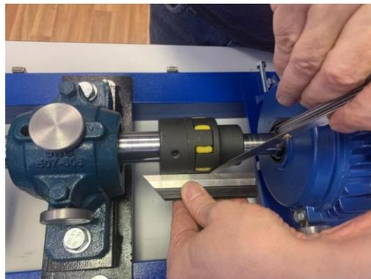
Корректировка положения двигателя по высоте осуществляется калиброванными пластинами.
